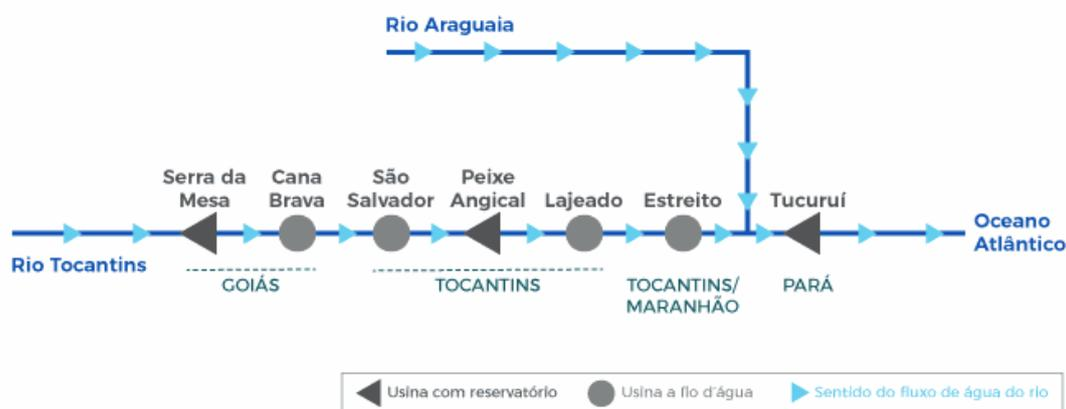
**FIGURA 23** – DIAGRAMA ESQUEMÁTICO ANA DE HIDRELÉTRICAS DA BACIA HIDROGRÁFICA DO RIO TOCANTINS
