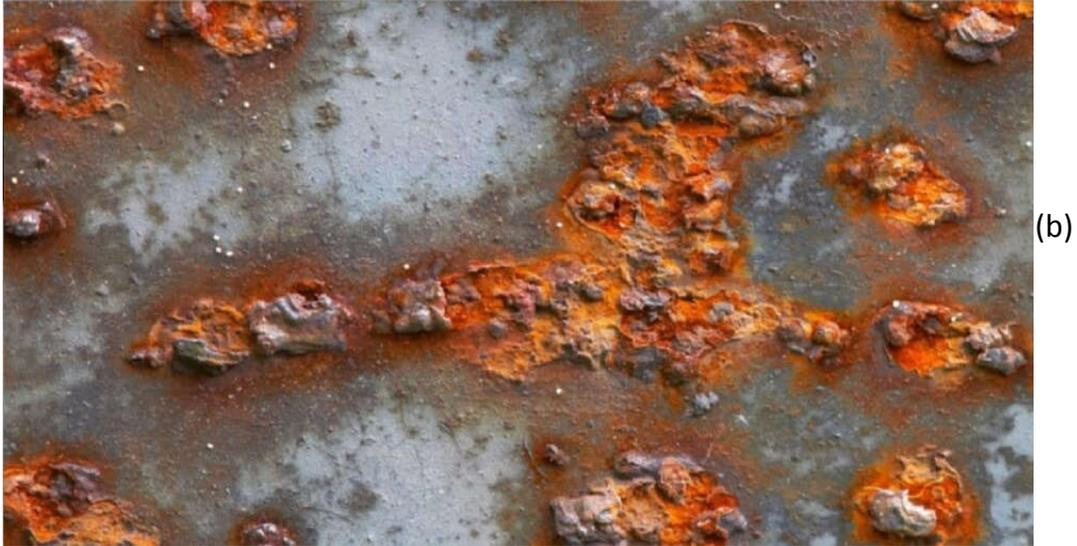
Figura 7 – Corrosão causada por incrustação.
